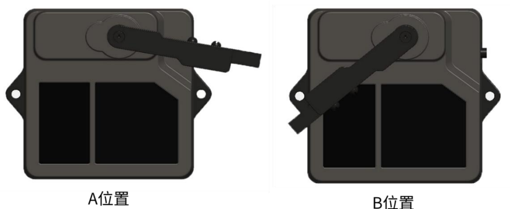
图 3-1 TF02-Pro-W-485 除尘刷运动起始位置示意
